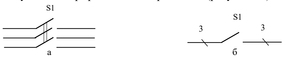
а – многолинейное изображение; б – однолинейное изображение Рисунок 9.2 – Фрагмент схемы электрической принципиальной
