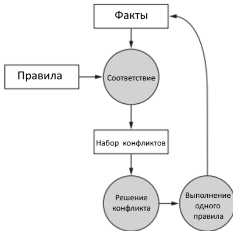
Рис. 2. Принцип применения правила и разрешения конфликтов в механизме логического вывода
