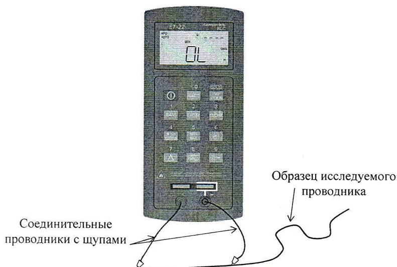
Рис. 1.9. Измерение сопротивления проводника RLC -метром
