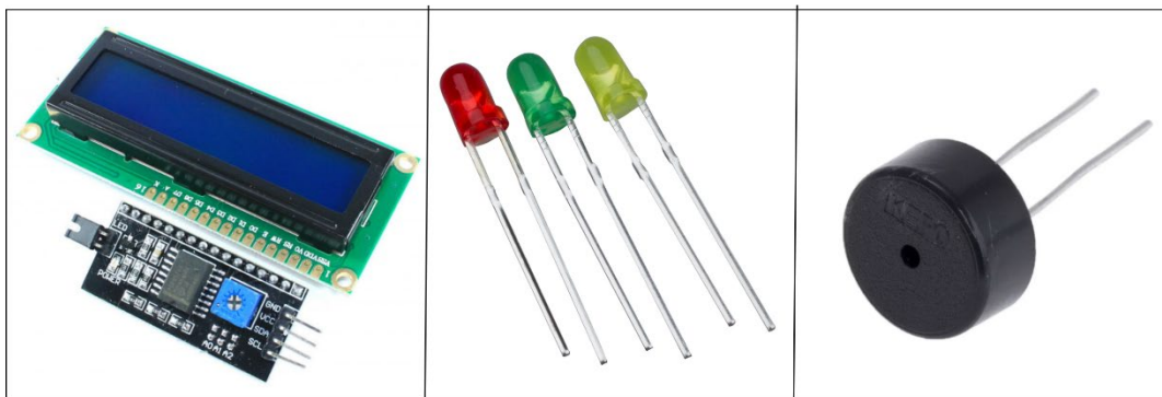
Рис. 11. Дисплей LCD1602 и I2C адаптер, светодиоды, пьезоэлектрический динамик.
