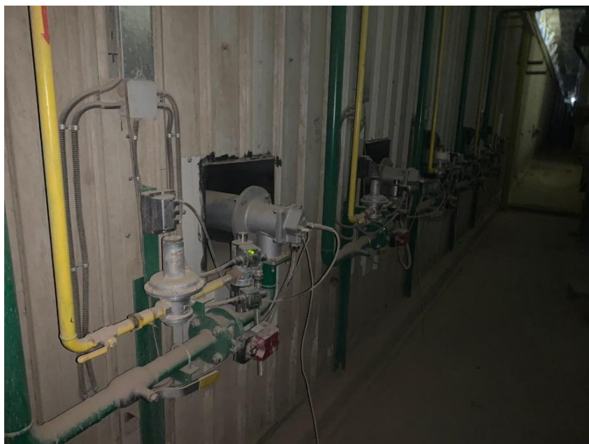
Рис. 2. Боковые горелки в зоне подготовки туннельной печи
