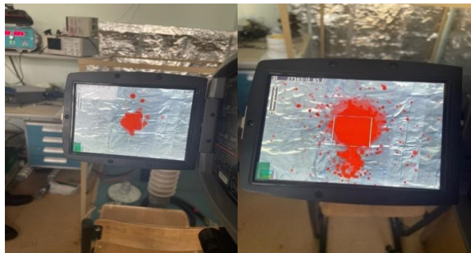
Рис. 3. Разряды при 10 кВ (слева) и 40 кВ (справа)
