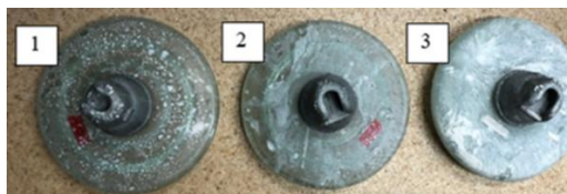
Рис. 5. Стеклянные изоляторы различной степени загрязнения: 1 – «нормальное» состояние изолятора (плотность покрытия 0,06 \text{ мг/см}^2 ); 2 – «ухудшенное» состояние изолятора (плотность покрытия 0,2 \text{ мг/см}^2 ); 3 – «предаварийное» состояние изолятора (плотность покрытия 0,4 \text{ мг/см}^2 )
