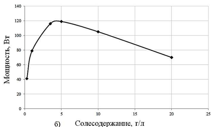
Рис. 2. Зависимость мощности от солевого содержания высококонцентрированного (а) низкоконцентрированного (б) растворов
