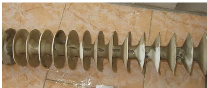
Рис. 1. Трещины на поверхности изолятора
