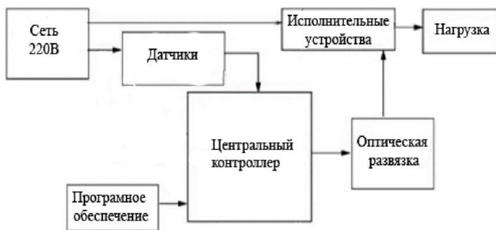
Компоненты автоматизированной системы управления электроснабжением в ЖКХ
